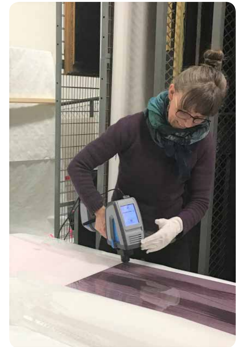
Anja Sandtrø utfører FTIR-analyser av Marit Aanestads Pleksicollage.
